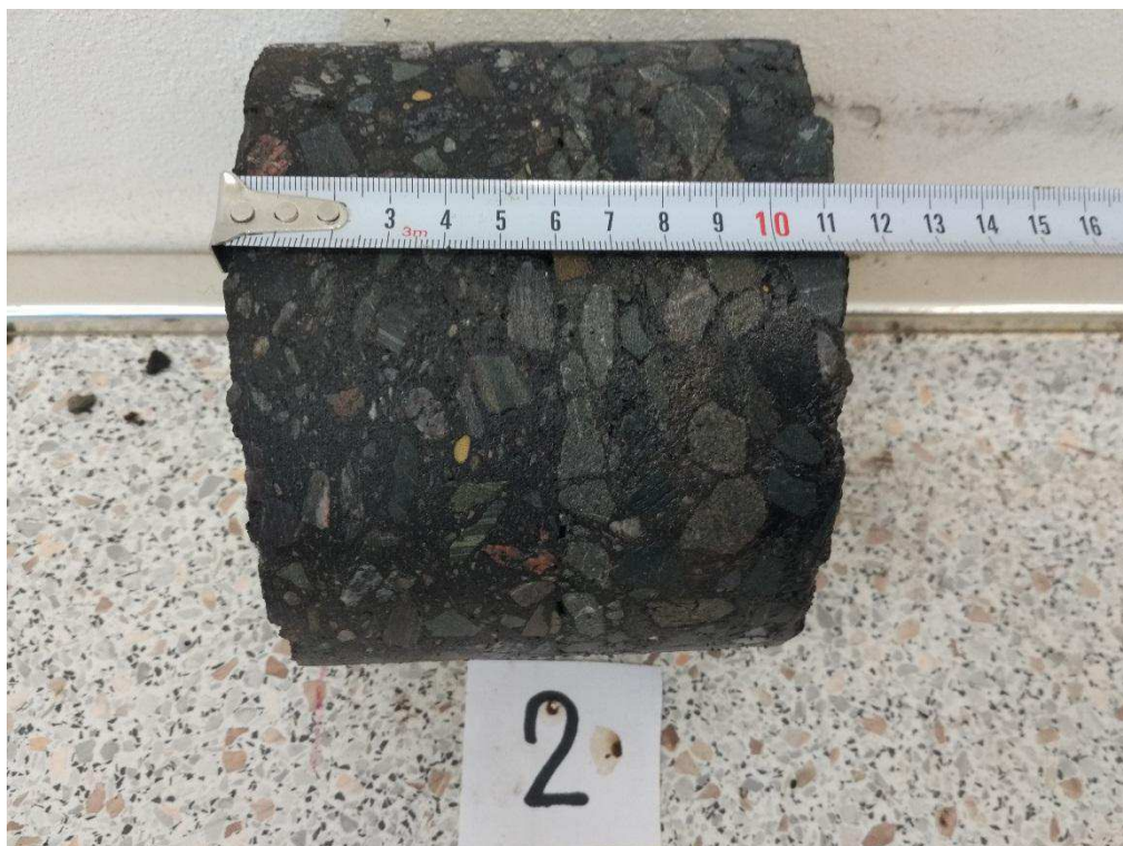
Obr. 26 AC vývrt JV8, most 644-003 Pěčíkov - Hraničky
