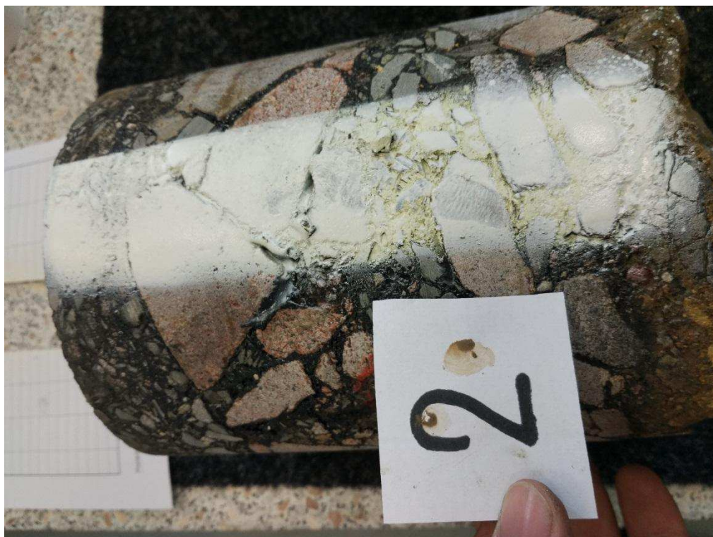
Obr. 28 Detail přítomnosti PAU na AC vývrtnu JV2
