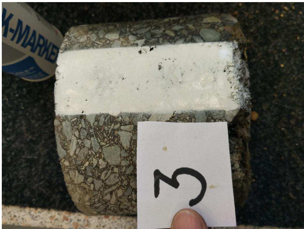
Obr. 29 Detail negativní přítomnosti PAU na AC vývrtnu JV3
