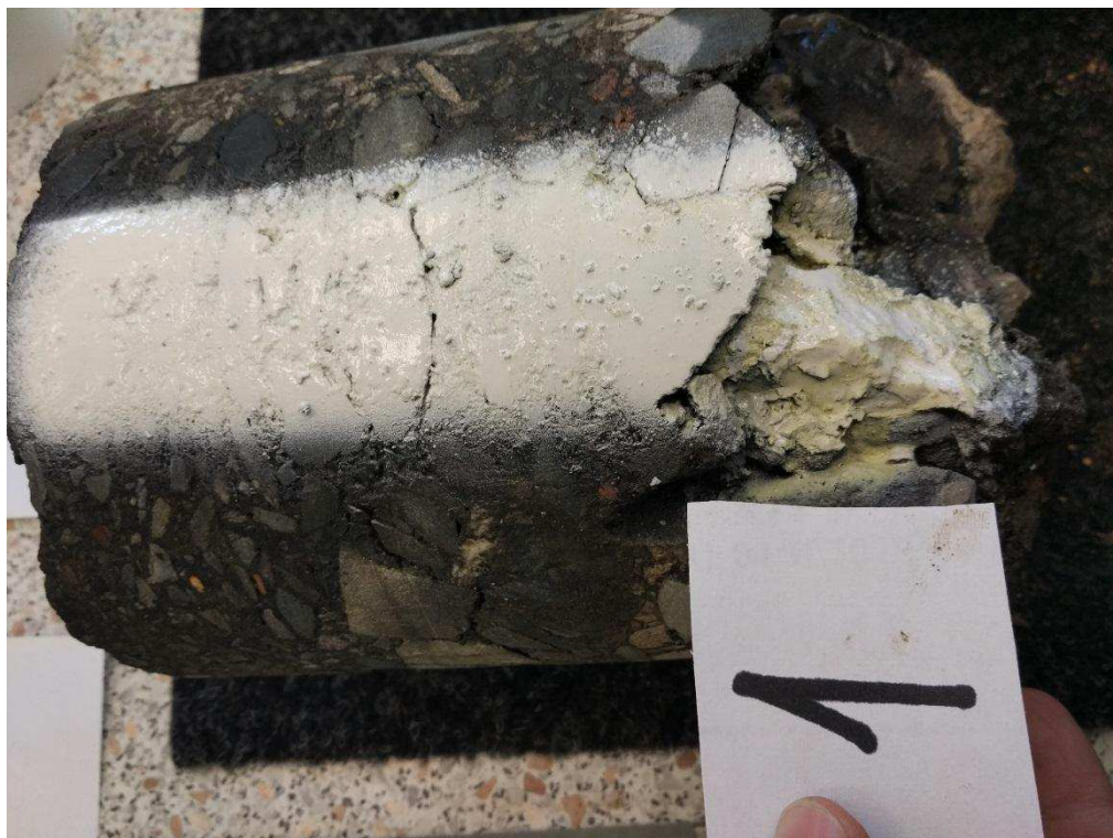
Obr. 27 Detail přítomnosti PAU na AC vývrtnu JV1
