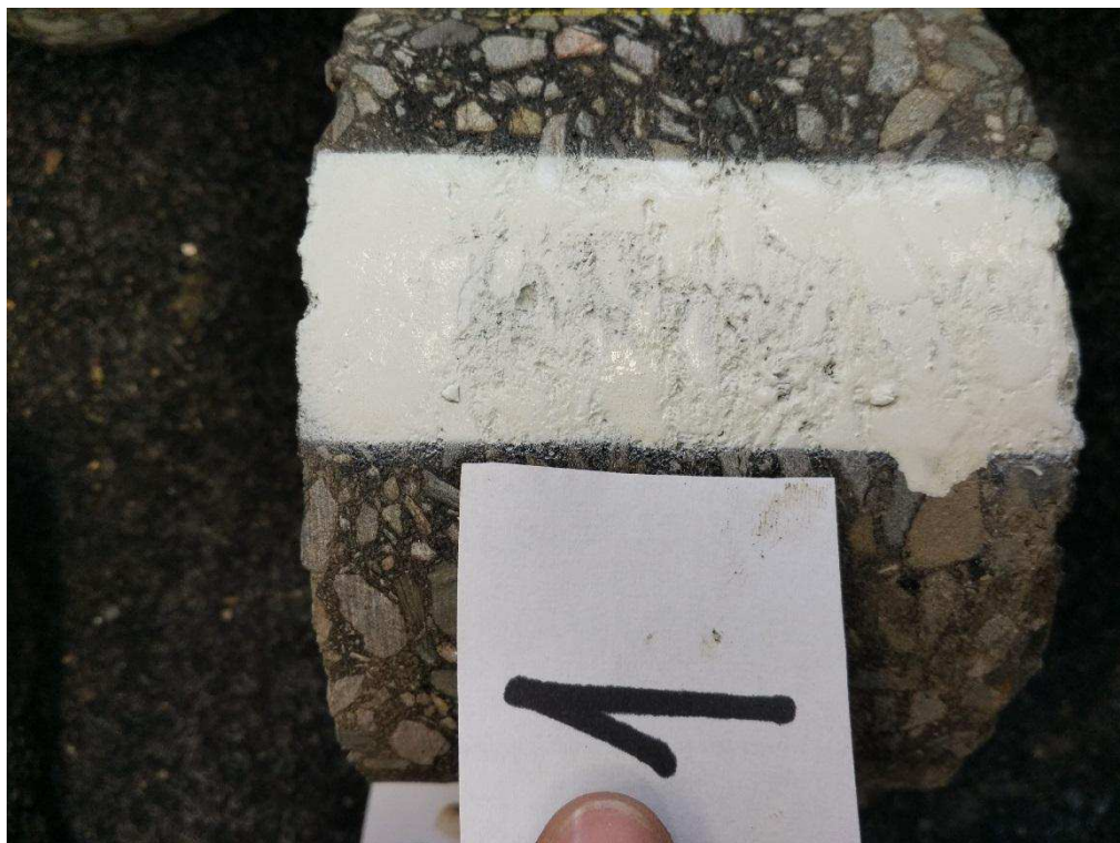
Obr. 33 Detail negativní přítomnosti PAU na AC vývrtnu JV7
